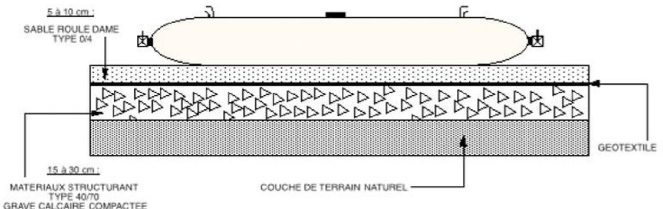
RESISTANCE GEOTECHNIQUE DE LA PLATEFORME : 1,6 T/m<sup>2</sup>
