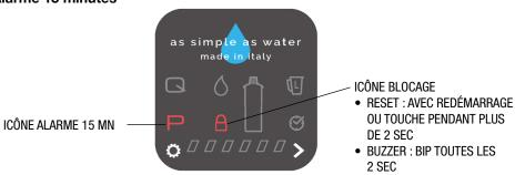
Cette fonction permet le blocage d'approvisionnement d'eau de service si le prélèvement a une durée supérieure à 15 minutes, afin d'éviter des inondations pour rupture du circuit en aval de la machine.
