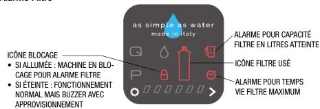
La carte prévient quand changer le filtre à charbon actif en fonction des paramètres configurables de temps et quantité d'eau traitée. Voir plus loin pour programmation.
