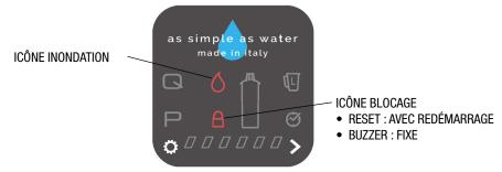
Une sonde de détection eau est installée dans la machine qui contrôle des fuites éventuelles. L'activation de cette alarme bloque complètement la machine. Une fois l'installation éteinte et le problème éliminé, cette alarme est réinitalisée quand on redémarre la machine.
