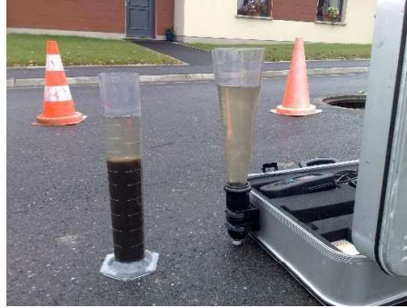
Mesure du volume de boues activées dans le SBR (à gauche) Mesure des matières décantables de la bouteille d'échantillonnage avec cône Imhof (à droite)
