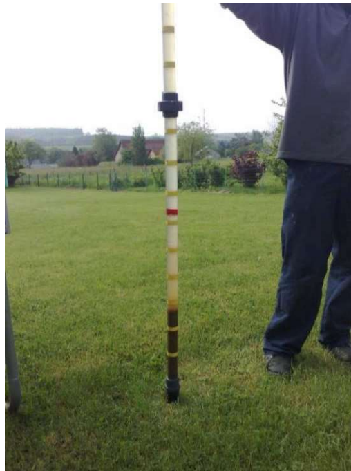
Mesure de niveau de boues dans le décanteur primaire
