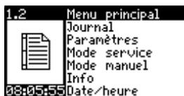
Vous pouvez au niveau principal accéder, à l'aide des touches OK, ↑ ↓ et encore OK, aux différents sous-menus qui vous permettront, par le biais du personnel spécialisé, d'obtenir d'autres informations ou de passer en mode manuel pour vérifier le fonctionnement de l'équipement électromécanique.
