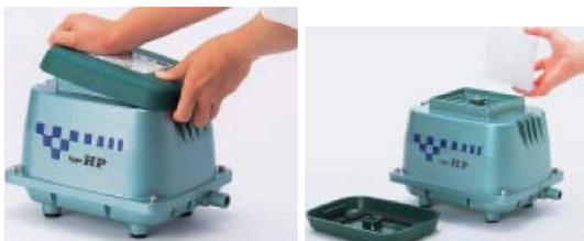
Retirer le filtre du capot supérieur pour le changer ou le nettoyer. A ce moment retirer toutes les particules et la poussière se trouvant à l'intérieur du couvercle du filtre d'aspiration. Si le filtre est sale dépoussiérez-le et si il y a de gros dépôts, nettoyez-le avec un détergent neutre et faites le sécher.
